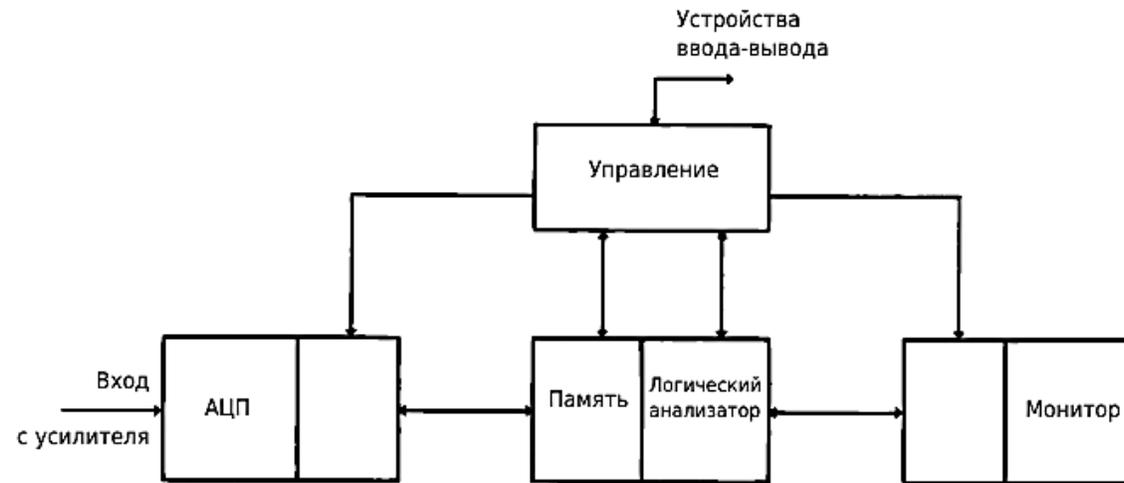
Рис. 2.15. Принципиальная схема мультисканального анализатора
