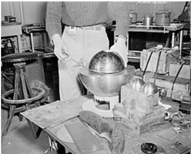
Воссоздание инцидента 1946 года. Плутоний скрыт под полусферой отражателя, удерживаемой отвёрткой
