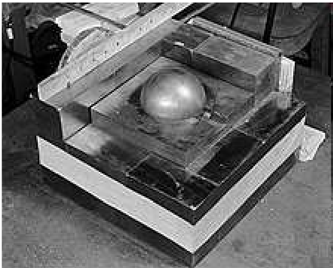
Моделирование инцидента 1945 года. Плутониевый шар окружён блоками из отражателя — карбида вольфрама
