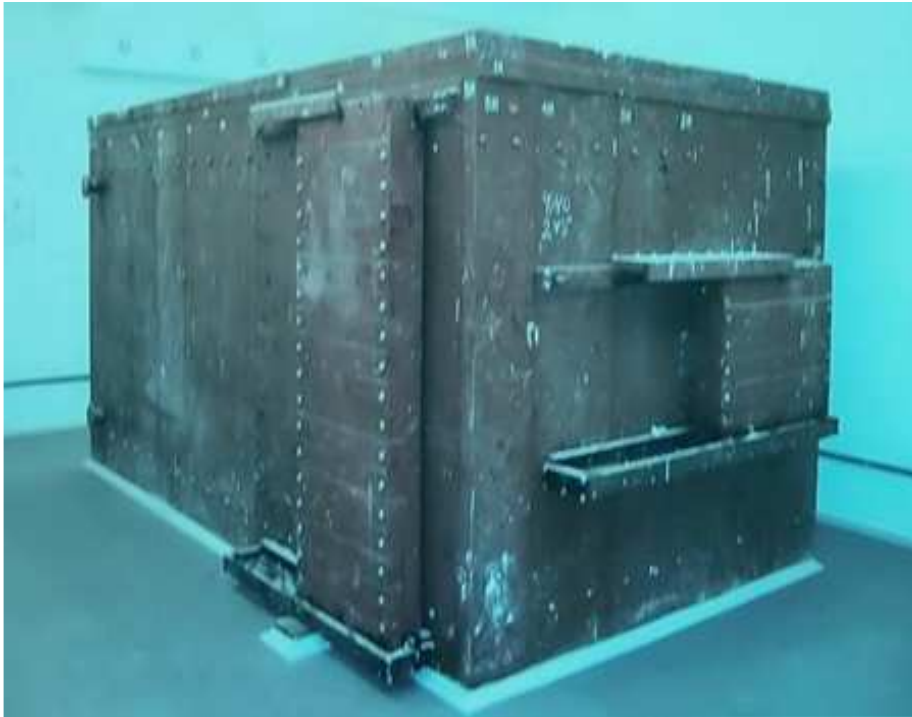
Комплекс спектрометров излучений человека СИЧ-Э — единственный в Европе. Стальная комната весит 90 тонн.
