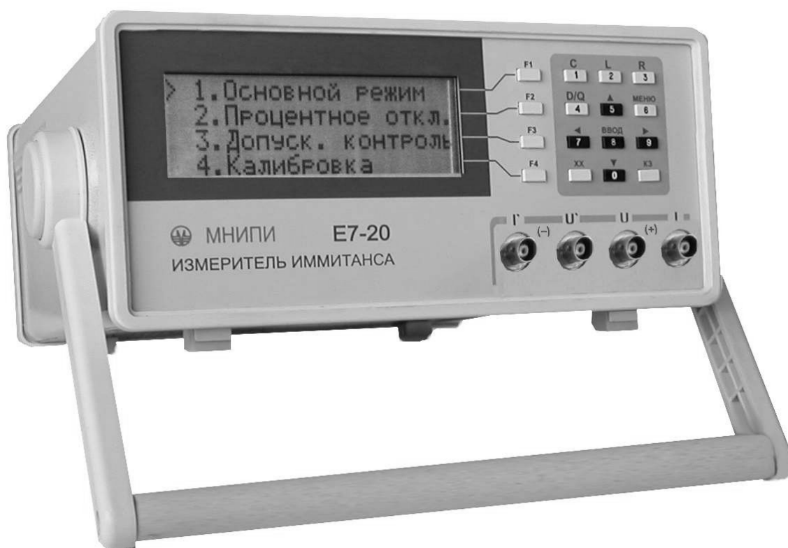
Рисунок 1.1 – Измеритель иммитанса E7-20. Внешний вид
