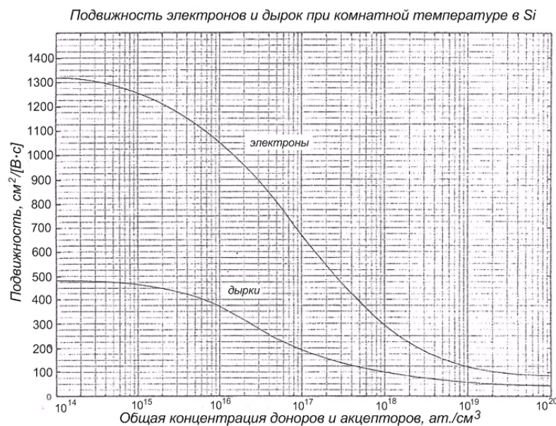
Рис. 6. Зависимость дрейфовой подвижности от концентрации носителей заряда
