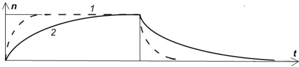
Рис. 8. Фотопроводимость при отсутствии (1) и наличии ловушек захвата (2)
