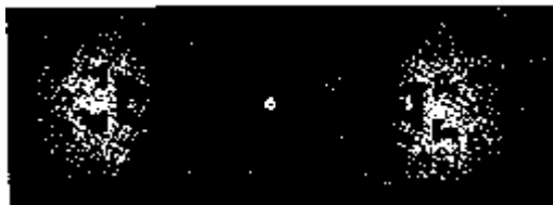
Рис. 19. Фотография изображений, восстановленных с голограммы Фурье
