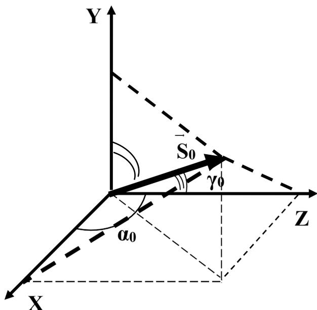
Рис. Угловые координаты  $\alpha_0, \beta_0, \gamma_0$  для волны, падающей на решетку.  $\vec{S}_0$  – единичный вектор, определяющий направление падения.
