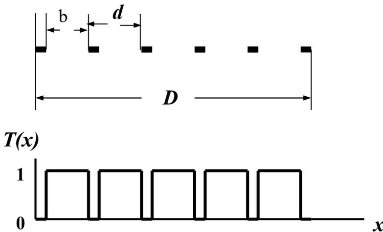
Рис.3.8. Функция пропускания одномерной дифракционной решетки
