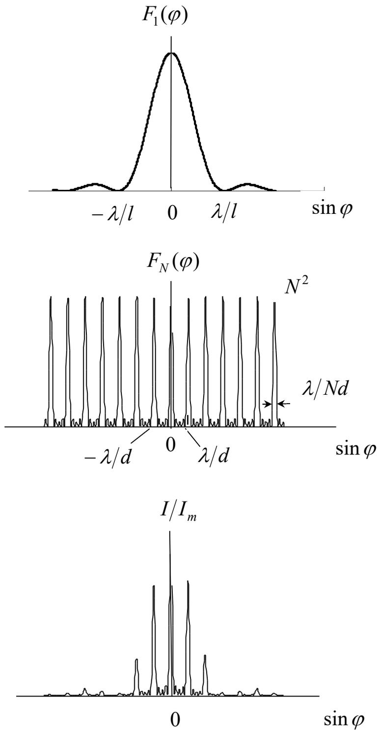
Рис. 3.9. Распределение интенсивности при дифракции на одномерной амплитудной решетке
